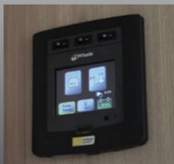
Whale Next generation heating system. Underfloor. Eenvoudig: -15° exterior en +20° interieur.
